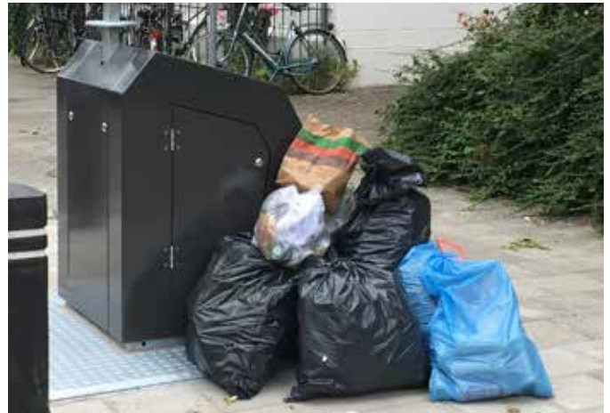
Utrecht wil bijplaatsingen zoveel mogelijk voorkomen door containers met vulgraadsensoren uit te rusten. Foto Eric Westzaan.
